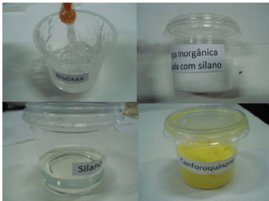
Imagem 5: componentes fundamentais de uma resina composta: matriz resinosa (Bis-GMA), partículas de carga (sílica), agente de união silano e o fotoiniciador canforoquinona.
