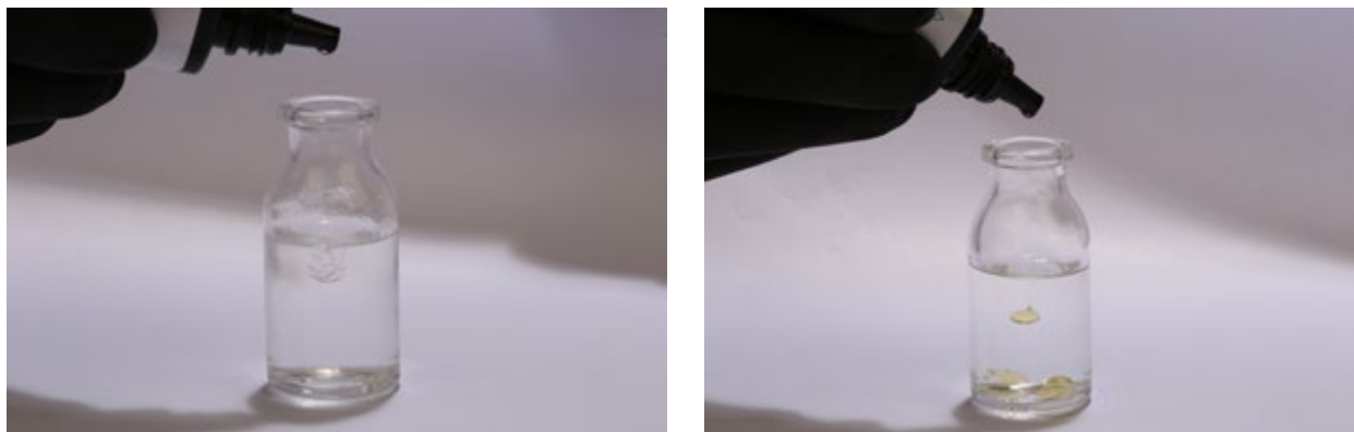
Imagem 6: Hidrofilia do primer (à esquerda) e hidrofobia do bond (à direita).
