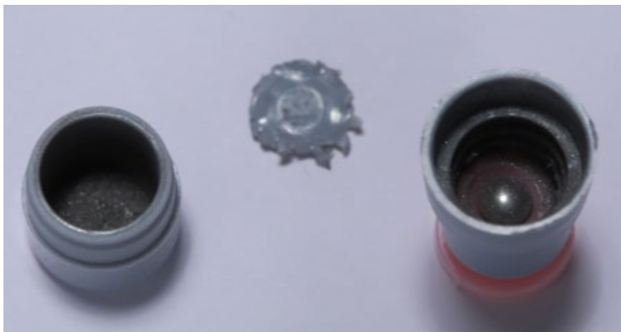
Imagem 13: Proporcionamento da liga metálica em pó e do mercúrio metálico líquido feito pela indústria dentro da cápsula.
