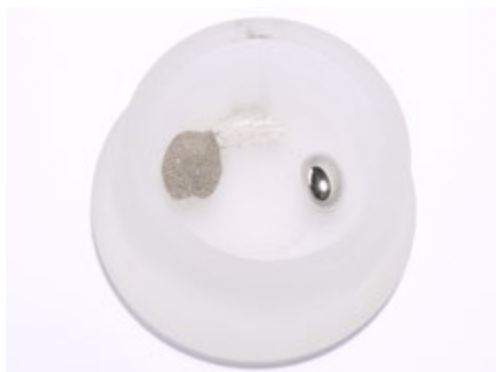
Imagem 5: Proporcionamento da liga metálica em pó e o mercúrio metálico líquido em peso
