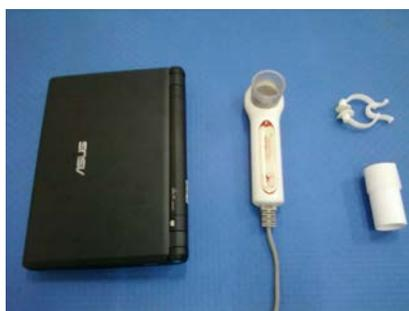
**Figura 1** - Espirômetro Microquark, Cosmed®.
