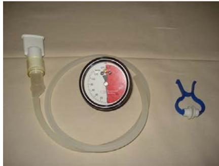
**Figura 4** - Clipe nasal e o Manovacúômetro comercial médica com intervalo operacional de 0 a 120 cmH<sub>2</sub>O.
