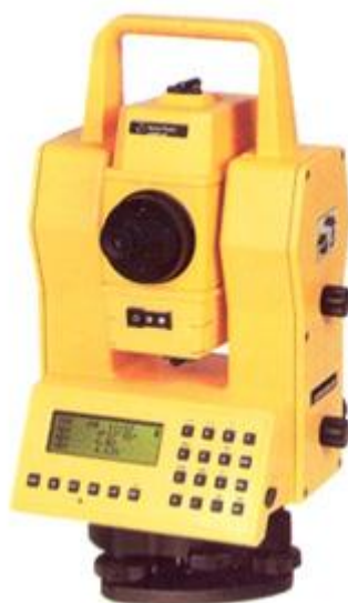
Figura 3: Teodolito eletrônico com visor de ângulos com display.
